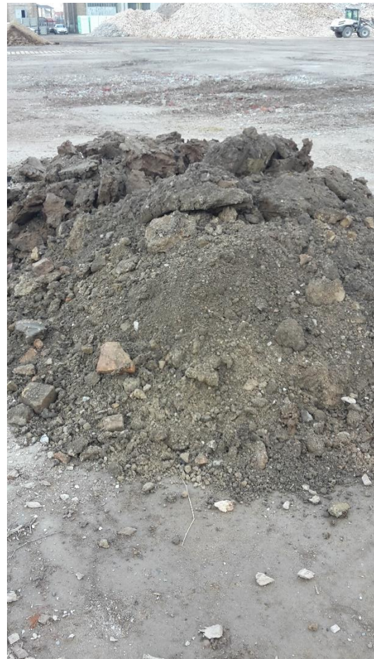
Abb. 2 Haufwerk aus Schurf S 6: Auffüllung
